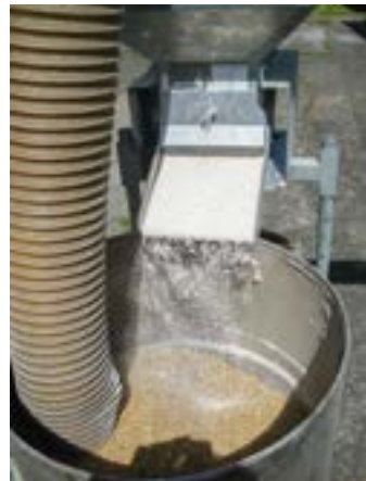
Applikator für Einmischung von Silico-Sec in Getreide
